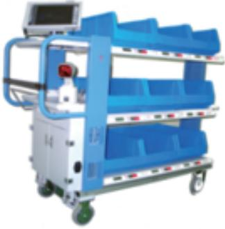
피킹카트에 장착된 웹패드 및 피킹 후 원활한 상품분류를 위한 표시기를 장착하여 신속하게 피킹 할 수 있는 DPS/DAS를 결합한 시스템입니다.
